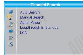
Pulse **MENU**, seleccione *Búsqueda de Canales* y pulse **OK**. Luego, seleccione *búsqueda automática* y pulse **OK**.
