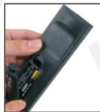
Inserte una nueva pila con el polo + hacia arriba
